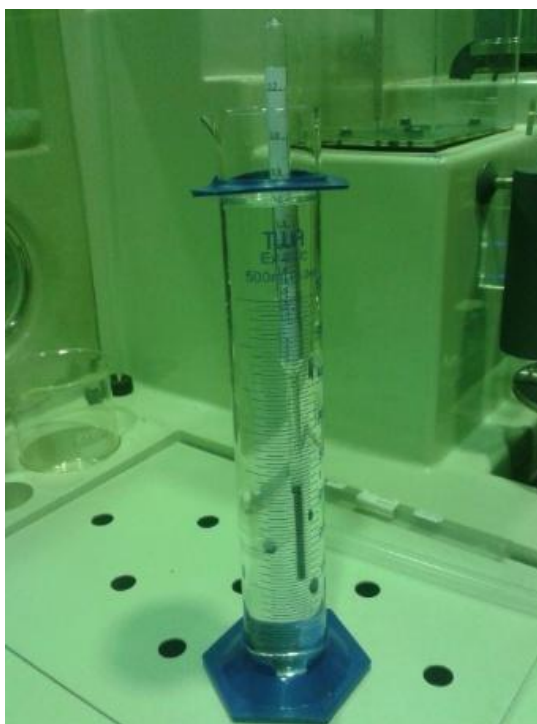
Figura 05 – Medição da densidade relativa por meio do densímetro.
