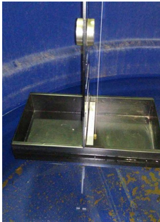
Figura 09 – Apresentação do corpo flutuante utilizado no experimento.
