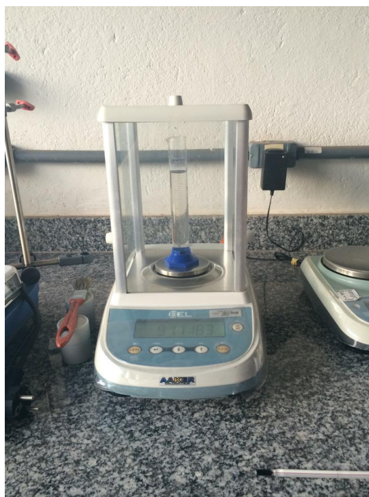
Figura 03 – Proveta contendo água para medição da massa e específicos.
