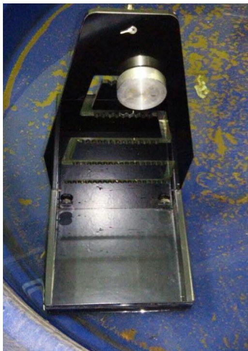
Figura 08 – Equipamento para determinação do equilíbrio de um corpo flutuante.
