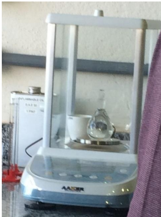
Figura 04 – Determinação da massa específica da água utilizando o Picnômetro.
