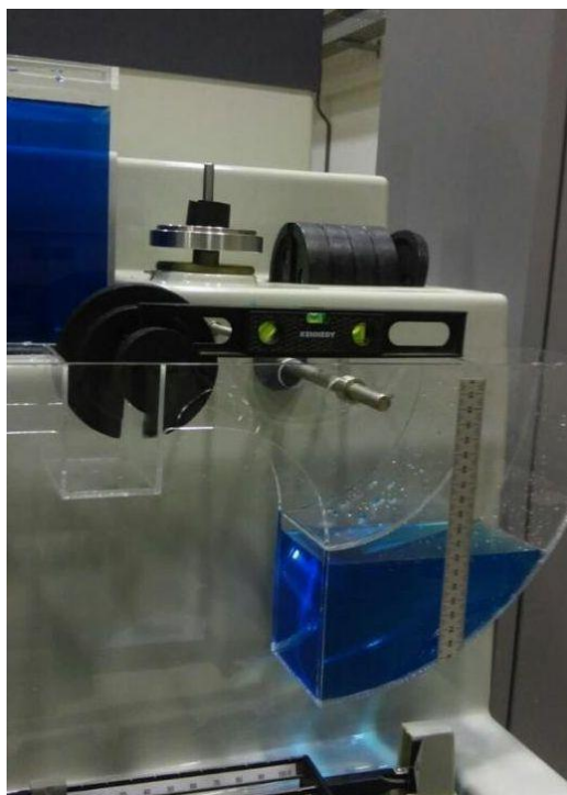
Figura 07 – Determinação das forças planas submersas.
